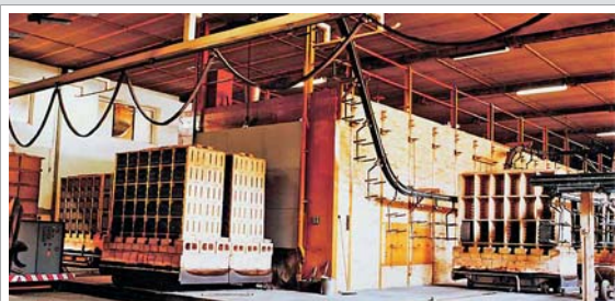
SEINERZEIT EINEN SCHRITT VORAUSS: 1960 nahm Meyer-Holsen den ersten Dachziegel-Tunnelofen in Betrieb - eine wegweisende Neuerung für die gesamte Branche.
